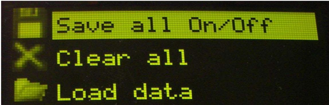
第一个选项允许用户将测量结果保存到 MRAM 中。启动存储功能后，血压计将保存最新测得的结果。每次血压计在系统上最多可以保存五条记录（5 个测量集）。
